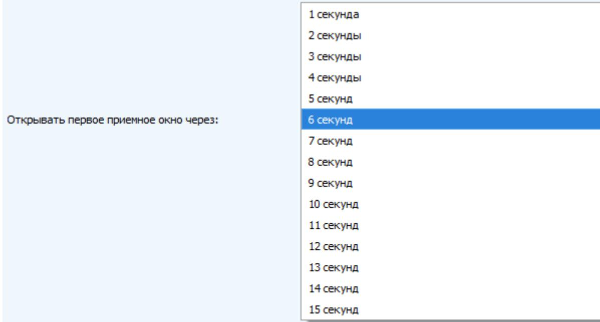
**Задержка 1 на подтверждение присоединения к сети:** (не отображается в режиме «Простой») – опция задаёт время, через которое устройство откроет первое приёмное окно для получения подтверждения присоединения к сети LoRaWAN при работе в режиме присоединения OTAA. Второе окно всегда открывается через 1 секунду после первого.
