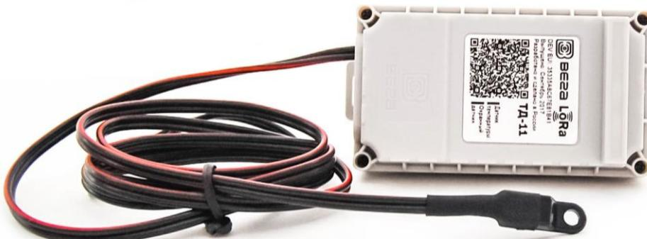
Элементом питания для термодатчика служит встроенная батарея ёмкостью 3400 мАч, рассчитанная на срок службы до 10 лет при передаче данных один раз в сутки.
