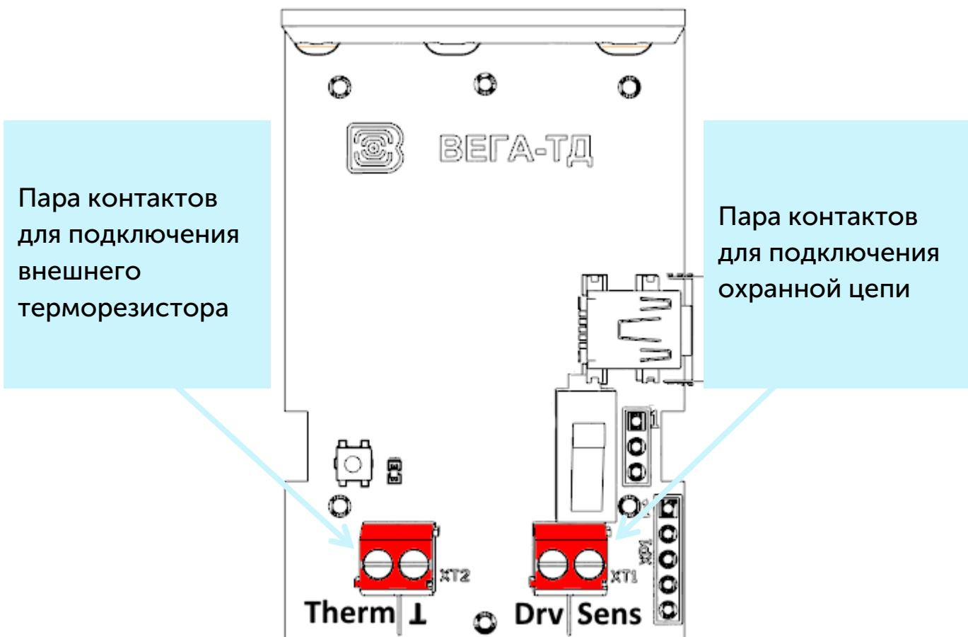
Термодатчик имеет 2 пары контактов. К одной паре (контакты «Therm» и «
